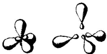
Slika 24.12. Levo: raspodela gustine četiri elektrona u slučaju tetragonalne ( sp^3 ) hibridizacije ugljenika. Desno: slika sa rastavljenim elementima radi preglednosti.
