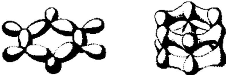
Slika 24.15. Raspodela gustine elektrona u benzenu, C_6H_6 . Levo, niz trougaonih sistema u šestočlanom prstenu benzena ( \sigma veza). Desno, raspodela gustine \pi stanja, koja se grade od p_z orbitala sa šest ugljenikovih atoma.
