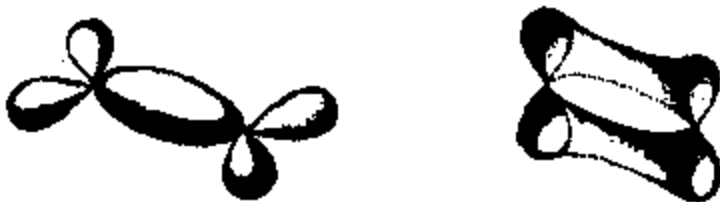
Slika 24.14. Raspodela gustine hibridiziranih elektrona ugljenika u eten C_2H_4 . Levo, Dva ugljenikova atoma su locirana na dva čvora zajedno sa njihovim vezanim elektronima. Desno: p_z funkcija dva atoma ugljenika, koji su orijentisani normalno na ravan trigonalne veze, grade sekundarnu ugljenik-ugljenik vezu.
