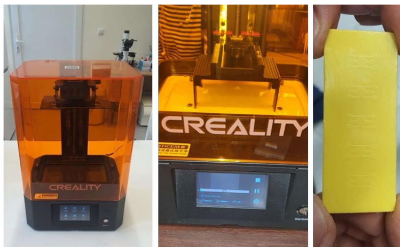
Слика 21. (А) 3D принтер Creality LD 006. (Б) 3D штампање. (В) Мастер модла.
