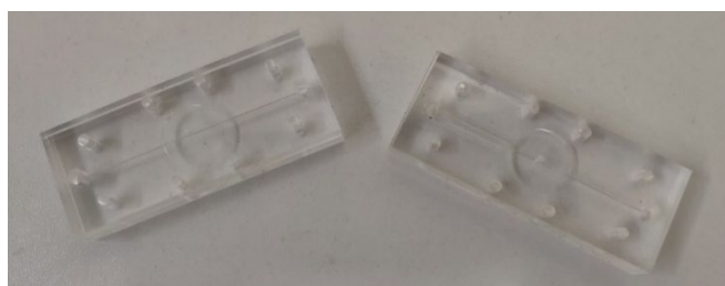
Слика 7. Прави модел након процеса глодања.
