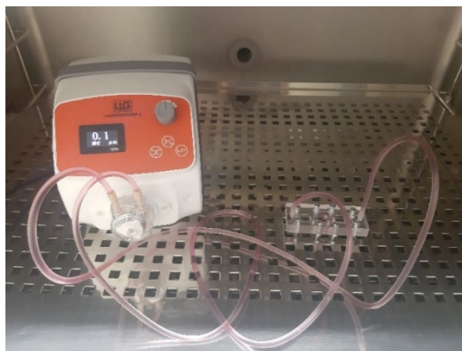
Слика 8. Чип повезан са перисталтичком пумпом са протоком.
