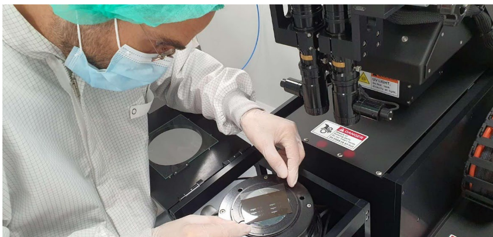
Слика 13. Излагање UV зрачењу у Mask aligner-а.
