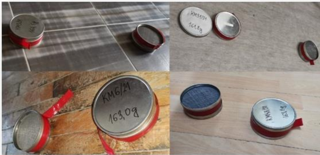
Слика 2.4 Угљени канистери на једном од мерних места (Gulan и др, 2023)
