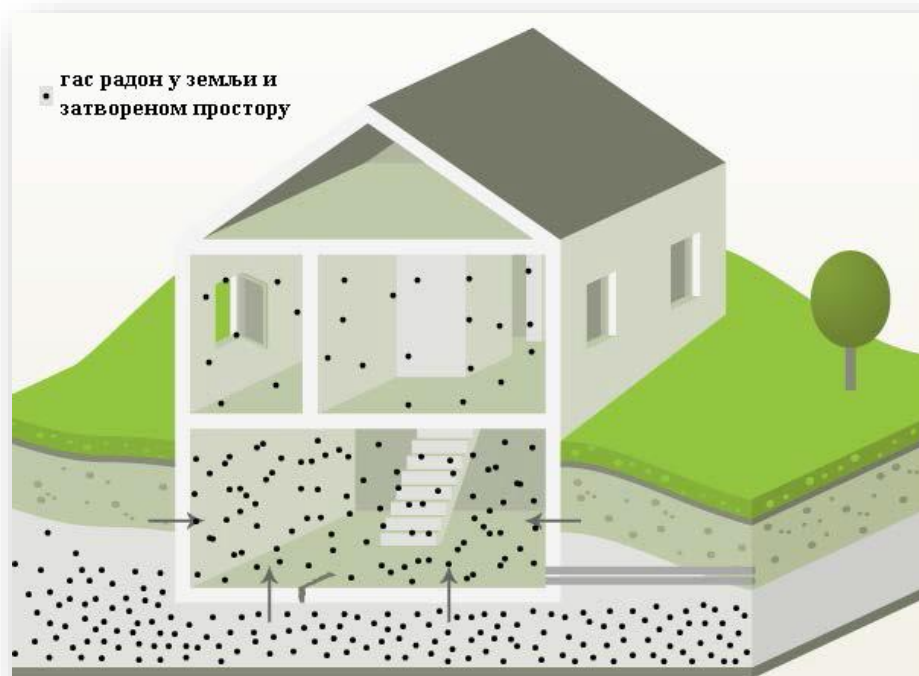
Слика 1.5 Продирање и нагомилавање радона у затвореном простору
