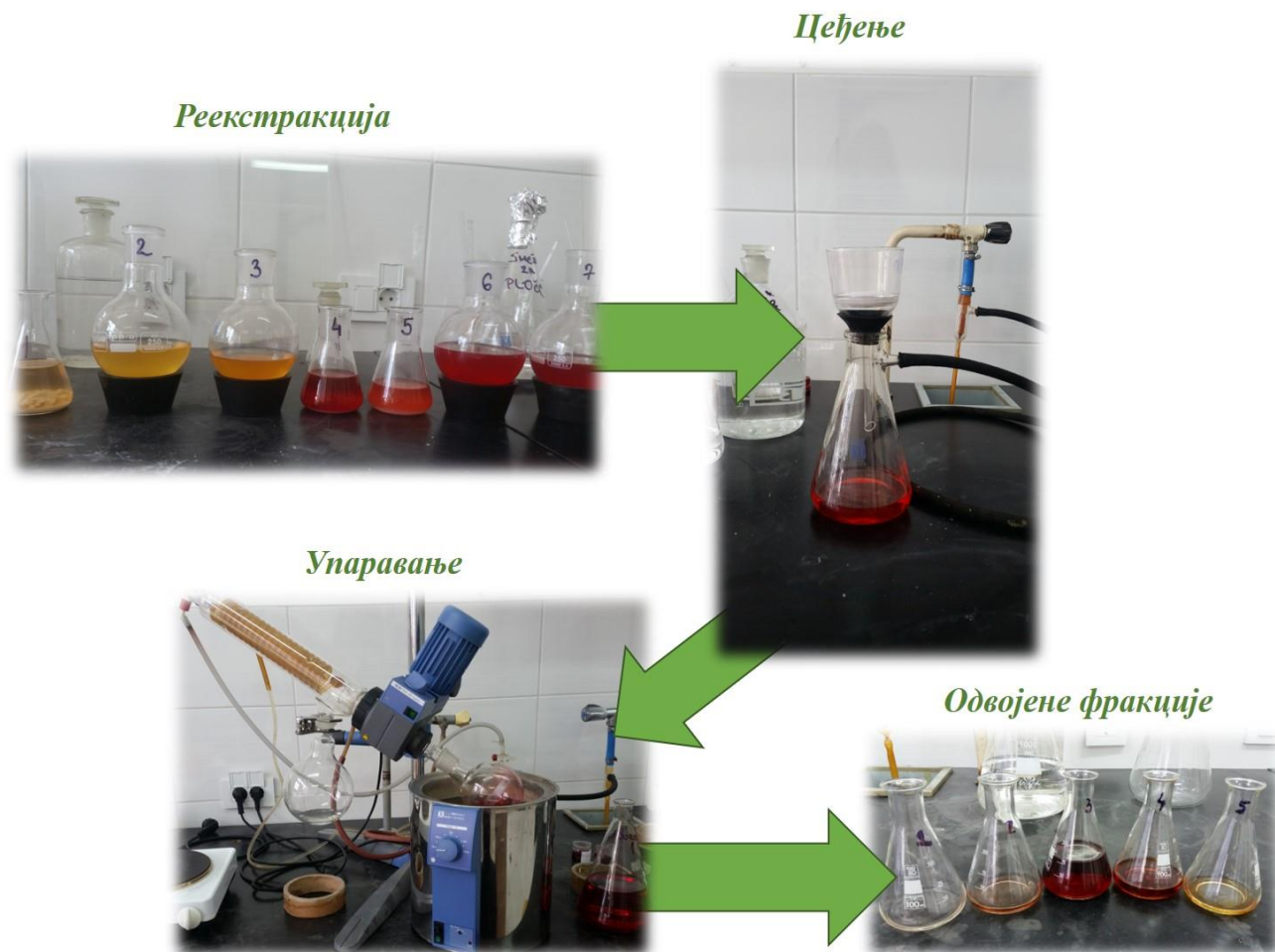
Слика 3.8. Процес реекстракције и добијања чистих фракција.
